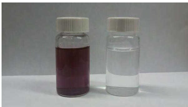
Figura 1. Comparación de agua tridestilada pura antes (vial de la derecha) y después (vial de la izquierda) de realizar ablación láser a un blanco de oro durante 15 min con pulsos de 8 ns de duración a una energía de 80 mJ a frecuencia de repetición de 10 Hz.
